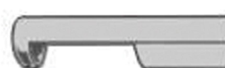
Um 90° nach unten geneigte, schmale Fußplatte
